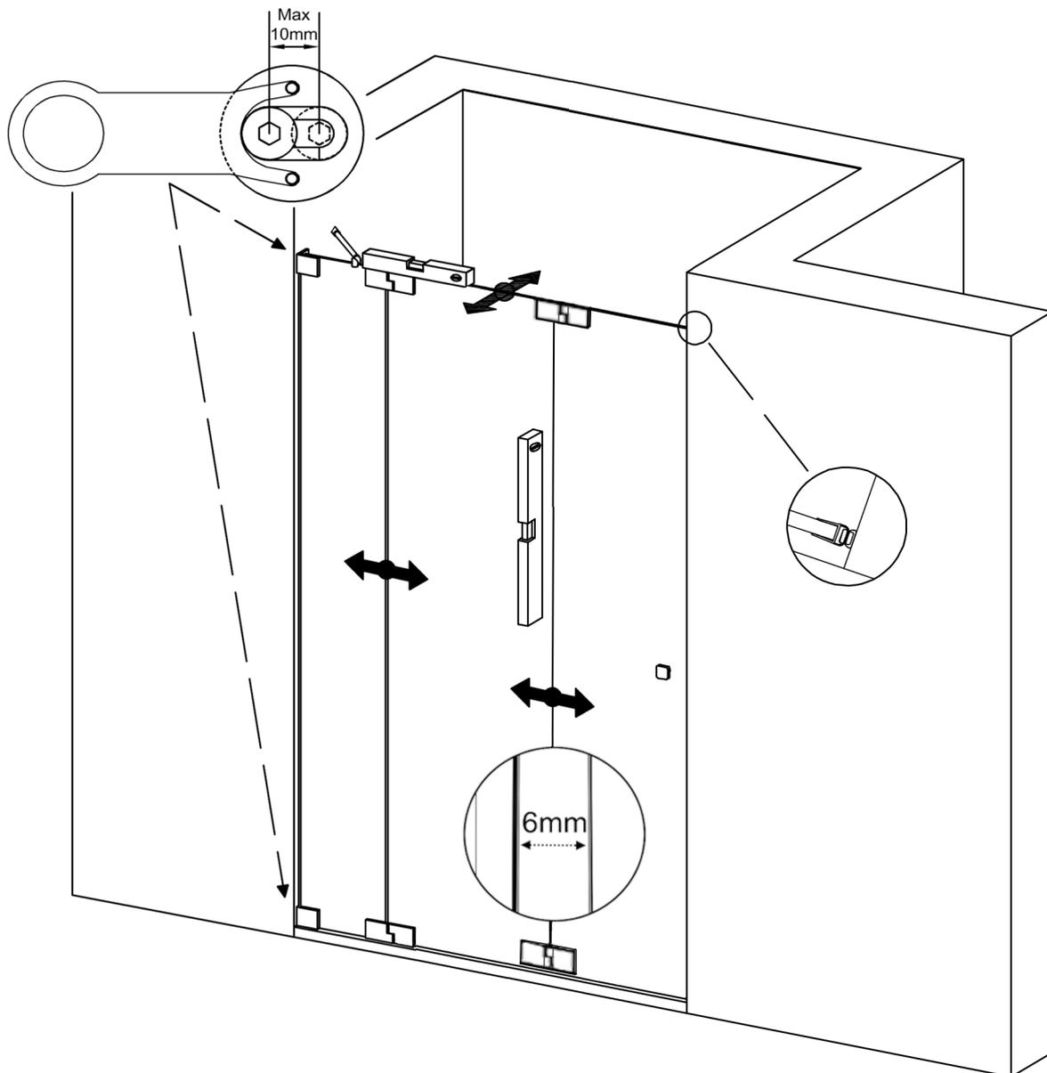
Richten Sie das Glas-Festteil senkrecht aus und fixieren sie die Inbus-Schrauben in den Langlöchern der Glasbefestigungen. Mit dem Montage-Schlüssel können die Glasbefestigungen dabei waagrecht gehalten werden. Schieben Sie dann das Kompensationsprofil (G13 / G13H) auf dem Glas mit Druck an die Wand, um Schrägen auszugleichen. Bei gerader Wand kann auf das Kompensationsprofil verzichtet werden und der senkrechte Wandanschluss absilikontiert werden (Abstand Wand / Glas min. 3 mm).
