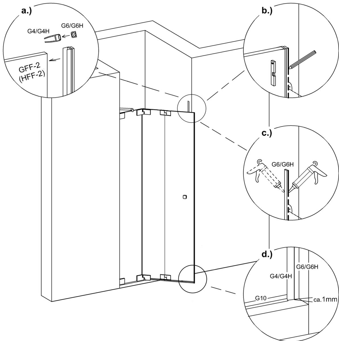
**a)** Kunststoff-Magnetprofil G4/G4H auf Türe aufstecken. Alu-Magnetleiste G6/G6H anhaften und ohne die Folie vom 3M Klebeband abzuziehen die Türe schließen.
