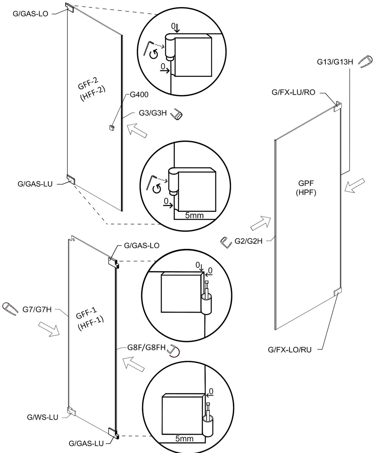
Bei gerader Wand kann auf das Kompensationsprofil G13/G13H verzichtet werden und der senkrechte Wandanschluss wird dann absilikoniert (Abstand Wand / Glas min. 3 mm).
