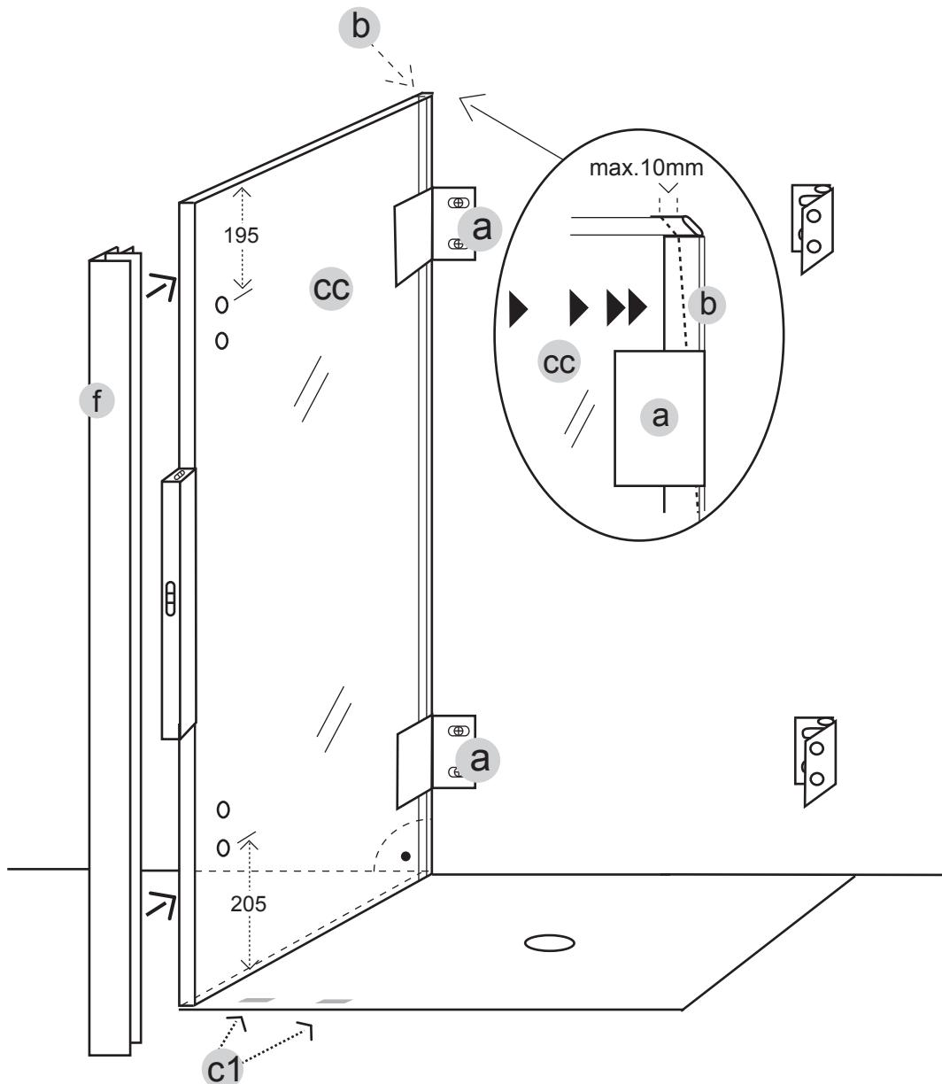
**D** Richten Sie die feste Seitenwand **cc** senkrecht aus und schieben Sie das Kompensationsprofil **b** mit Druck an die Wand um Schrägen auszugleichen. Fixieren Sie dann mit den Wandbefestigungen **a**. Bei gerader Wand kann auf das Kompensationsprofil **b** verzichtet werden und dersenkrechte Wandanschluss absilikoniert werden (Abstand Wand / Glas min. 2 mm).
