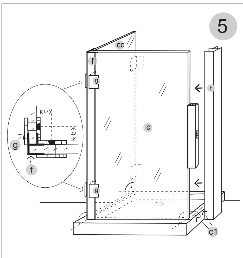
F Positionnez le paroi fixe **cc** d'aplomb et placez la plinthe de compensation **b** sur le mur en poussant fortement pour égaler les différences. Ensuite fixez la plinthe avec les vis de montage **a**. Avec des murs droits, il n'est pas nécessaire d'utiliser la plinthe de compensation **b**, on étanche avec un joint de silicon (distance verre / mur min. 2 mm).
